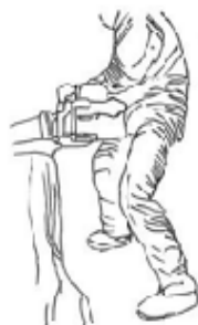
労働者の下肢の切創防止用保護衣の例 <図6>防護ズボン <図7>チャップス
